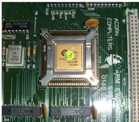
Foto del primo processore ARM, denominato "ARM1"
